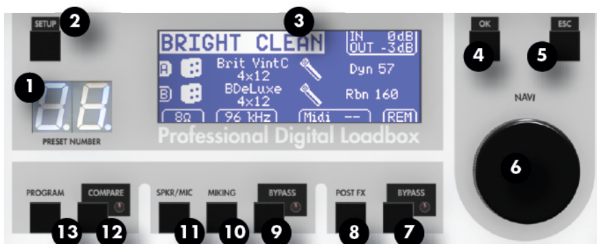
Figure 5.2 – Panneau de contrôle principal du Torpedo Studio
